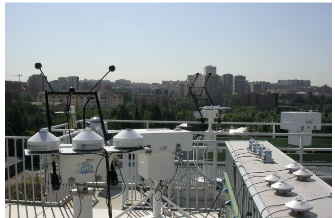
Figura 2.5.: Los piranómetros y pirheliómetros son calibrados periódicamente frente a sensores patrón.
